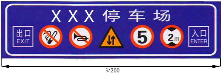
图B.6 告知标志牌示意及推荐尺寸（单位：cm）
